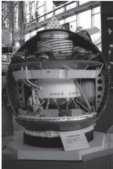
Corte del escudo térmico mostrando la cápsula de aterrizaje. Wikipedia. Dominio público.
