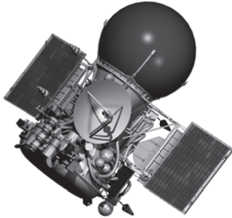
Modelo avanzado de Venera. La esfera superior contiene la cápsula de aterrizaje. NPO Lávochkin.
